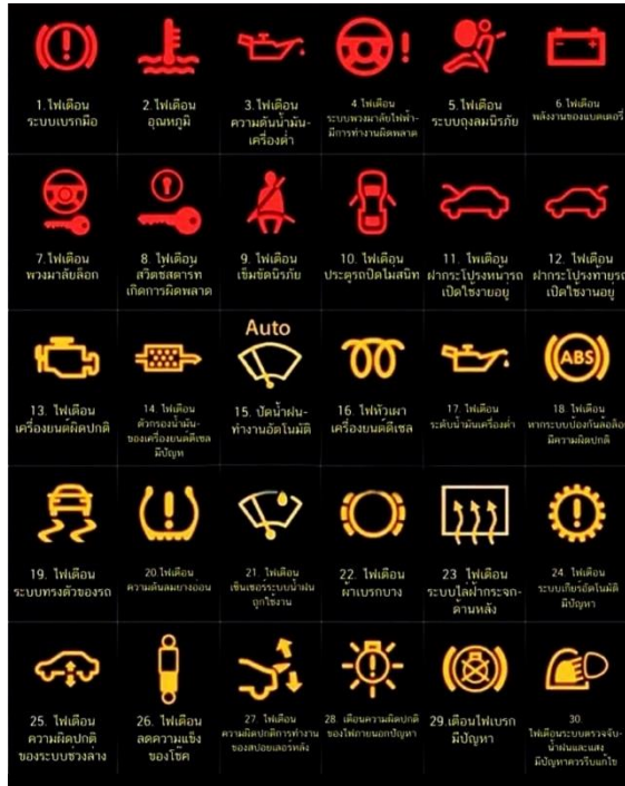
รูปที่ 1. ความหมายของสัญลักษณ์บนหน้าปัดรถ
